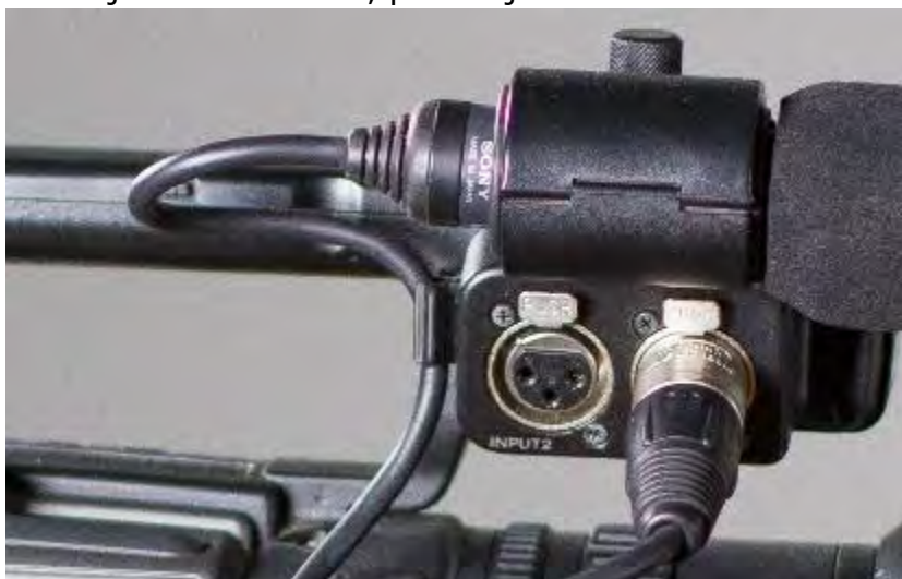
17. attēls - kameras skaņas panelis (XLR savienotāji)
